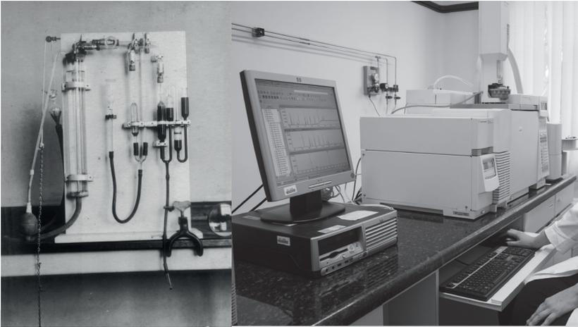
À esquerda, aparelho Holdane para análise do ar, modificado pelo professor Paula Souza; à direita, tecnologia de ponta para medição de nível de poluição do ar na sala de cromatografia do Laboratório de Análises da Exposição Humana e Contaminantes Ambientais
