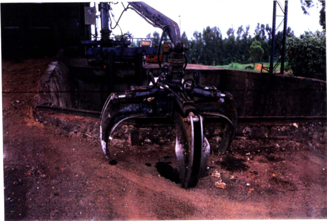
F5. Braço mecânico que lança o lixo no fosso.
