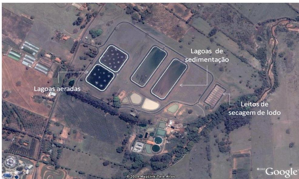
**Figura 47.** Estação de Tratamento de Esgotos por lagoas aeradas.
