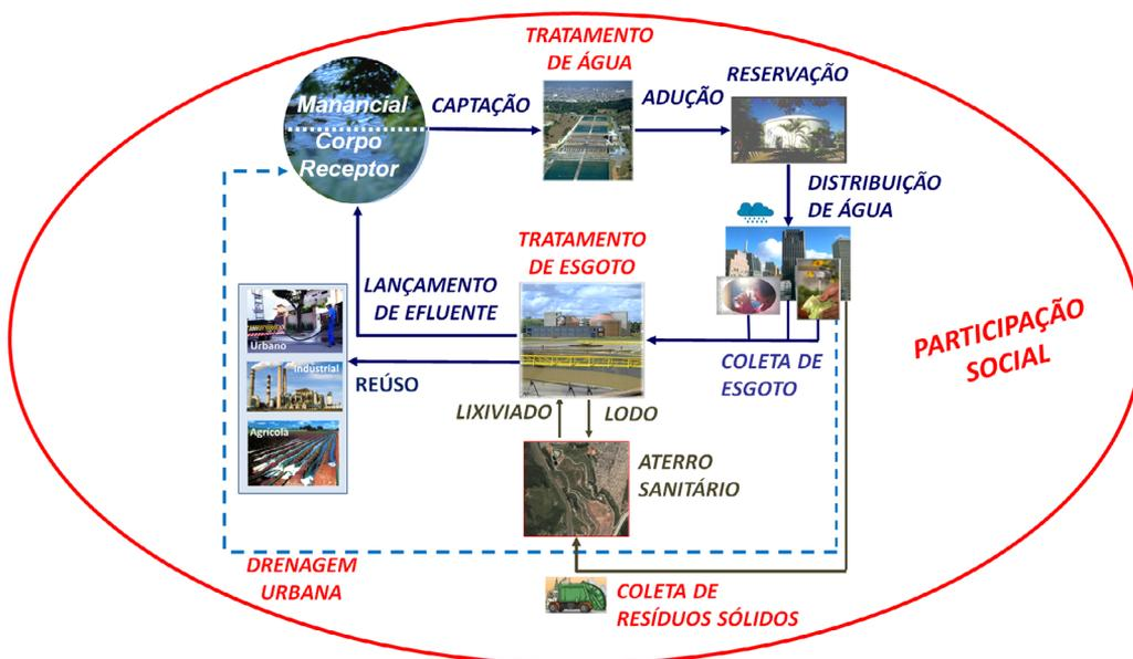
**Figura 3.** Ciclo do Saneamento: Água, Esgotos, Resíduos e Drenagem.
