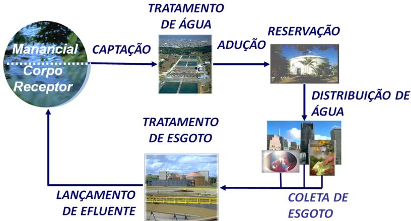
**Figura 2.** Ciclo da Água no Saneamento: a múltipla função dos corpos d'água.
